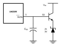
Figure 31. External 3.7V Soft-Start Clamp
